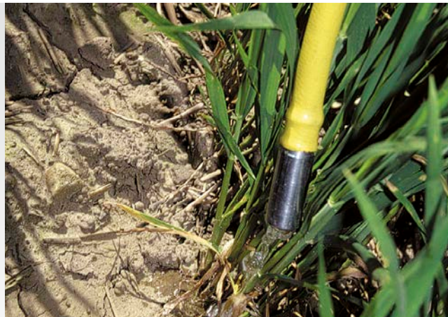
Masselotte en acier spécial sur le localisateur
